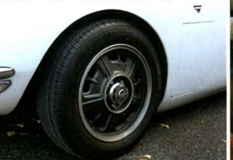
オリジナルのホイールはマグネシウム製ですが、R3000GTでは耐久性の高いアルミで復刻されています。デザインは忠実に再現されていますが、3リッターエンジン搭載によるハイパワ化に対応すべくリムはワイド化されています。ちなみに劇中のボンドカーはワイヤホイールでしたね。
