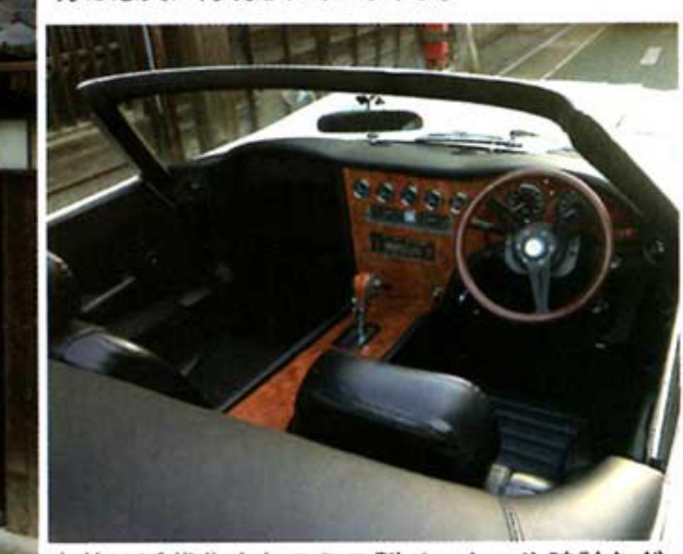
内装は近代化されスミス製メーターや時計などが装備されています。なおこの車はオートマ車で、ステアリングも小型化されています。全ては現代の交通事情に合わせ快適にドライブできるようにリメイクされています。もちろんエアコンやパワーステアリングも装備していますから快適で遠方までドライブできます。
